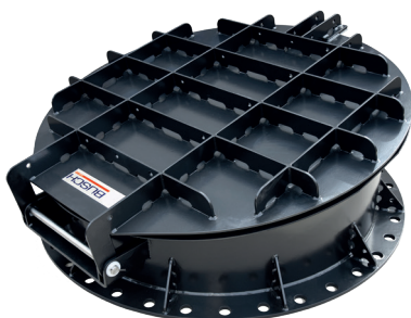
Koncová klapka DN 1400 z oceli 1.0038, lakovaná, varianta s šikmým víkem a tlumičem dorazu.
