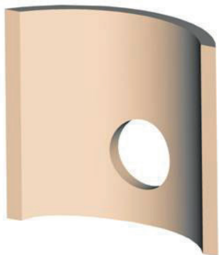
Příprava stěny šachty
